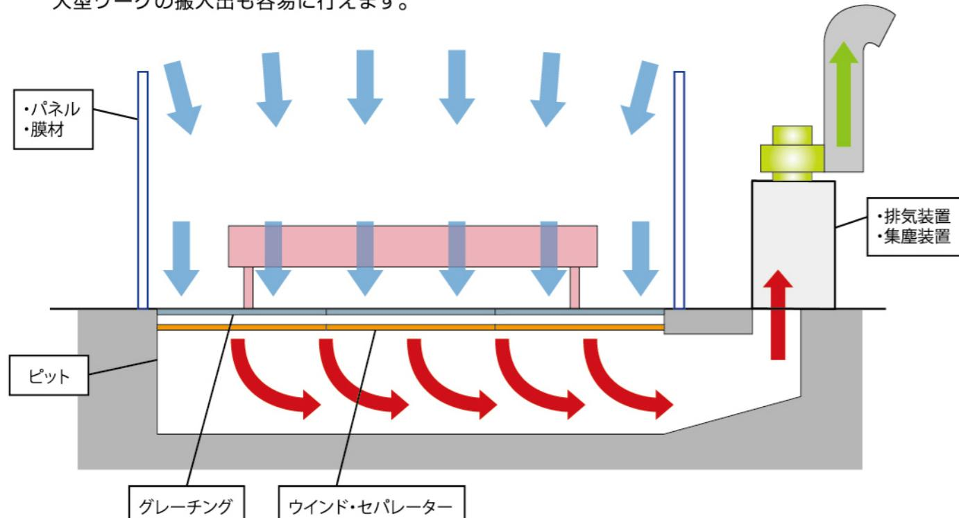
独自開発のウインド・セパレーターによる風量調整でブース内は均一で確かな風速が確保できます。
