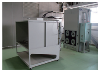
フィルター交換時はワークベンチを 脱着し、メンテナンスができます。
