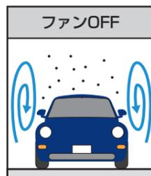
塗装終了時に一旦ファンを停止させ、再度乾燥モードでファンを動作させるので、急な圧力がかかりゴミブツ発生心配があります。
