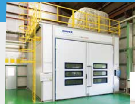
循環加温ヒートポンプ乾燥炉「CAB-OVEN」
