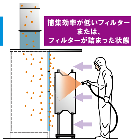
排気フィルターが詰まると吸込みが悪くなり、ミストが滞留します。
